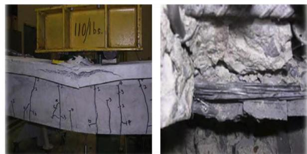
A) Concrete crushing B) FRP rupture
