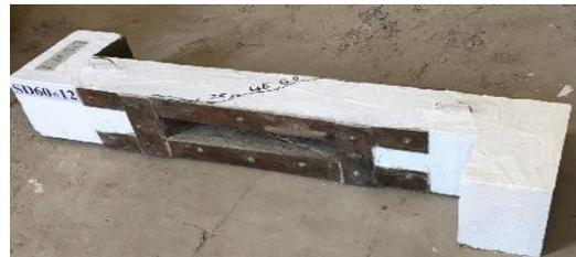
(d) Crack pattern for SD60x12
