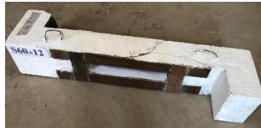
(d) Crack pattern for S60x12
