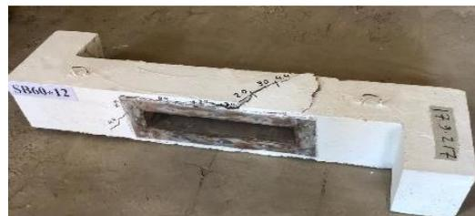
(d) Crack pattern for SB60x12
